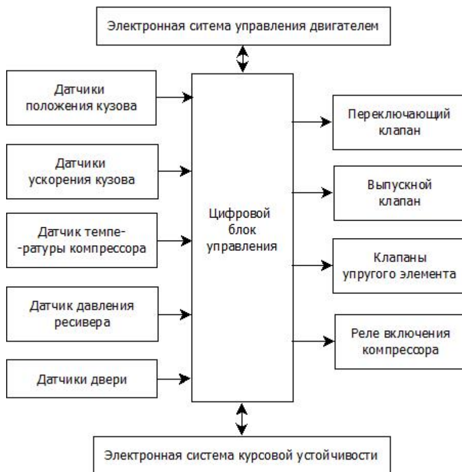
Рис. 1.3 Структурная схема регулирования клиренса автомобиля
