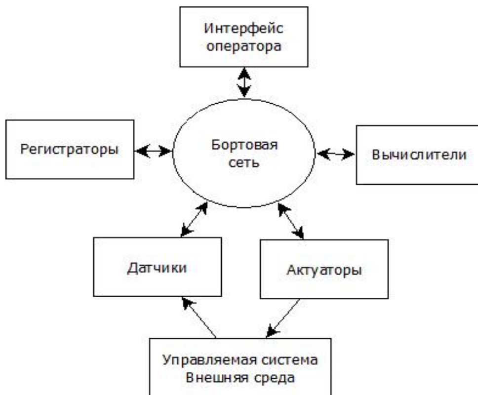
Рис.2.3. Бортовая сеть - средство связи и обеспечения процесса приема и передачи информации
