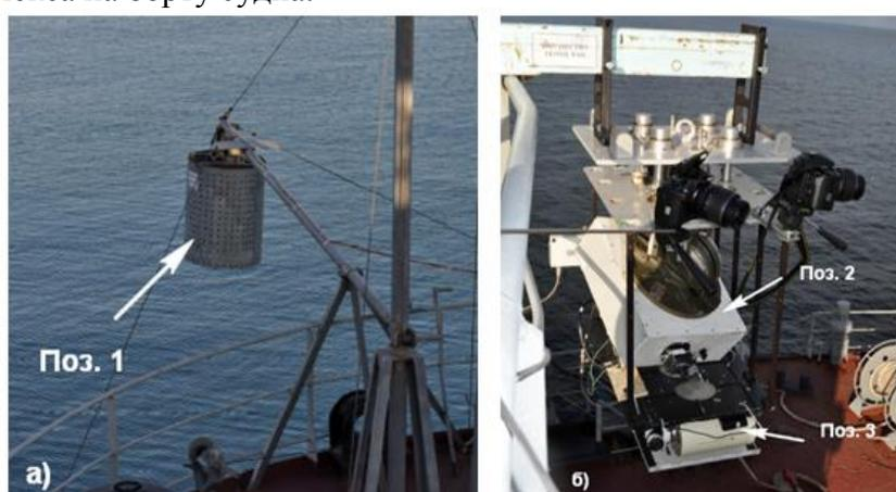
Рисунок 3.5 – Вид комплекса измерительной аппаратуры (а – размещение сканирующего локатора, б – размещение фотометра и аэрозольного лидара)
